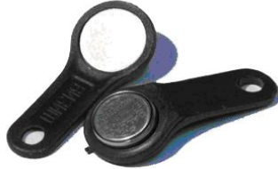
Рис. 18. Ключи системы Touch Memory (DS1990).
