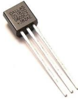
Рис. 8. Цифровой датчик температуры серии DS1820 (внешний вид может отличаться от представленного на рисунке)
