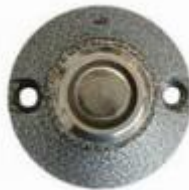
Рис. 19. Контактный считыватель ключей Touch Memory.
